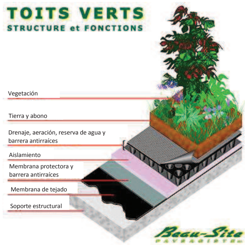
Figura 3. Esquema de un sistema completo de techo verde
