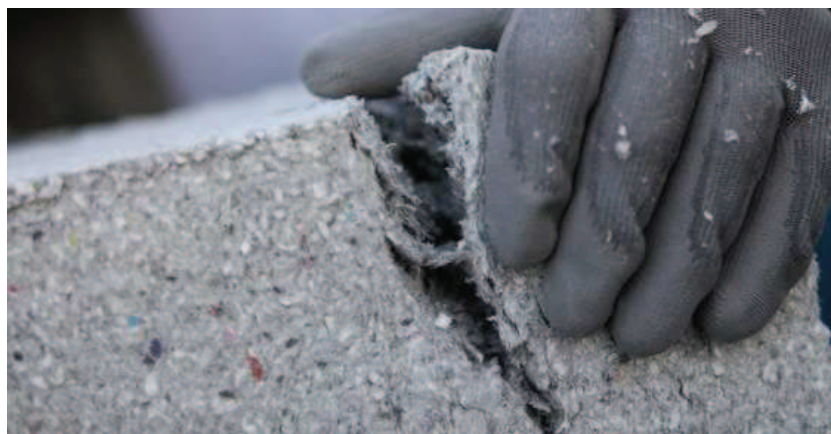
Figura 4. Material de aislamiento fabricado con diarios reciclados
