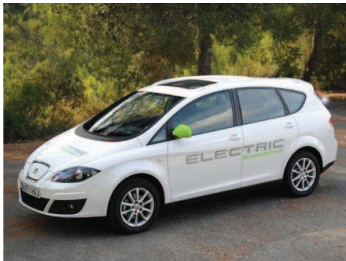
Figura 1. Coche con autonomía de 135 km que cuenta también con un sistema de captación de energía solar para la climatización
